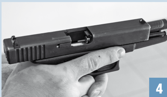
Zablokowanie pistoletu na skutek nieprawidłowego usunięcia niedomknięcia komory nabojeowej.
