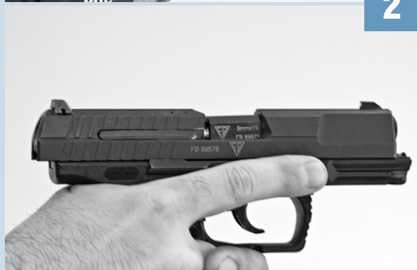
Niedomknięta komora nabojeowa. Podczas kontroli broni funkcjonariusz widzi kryzę łuski w oknie wyrzutu łusek.
